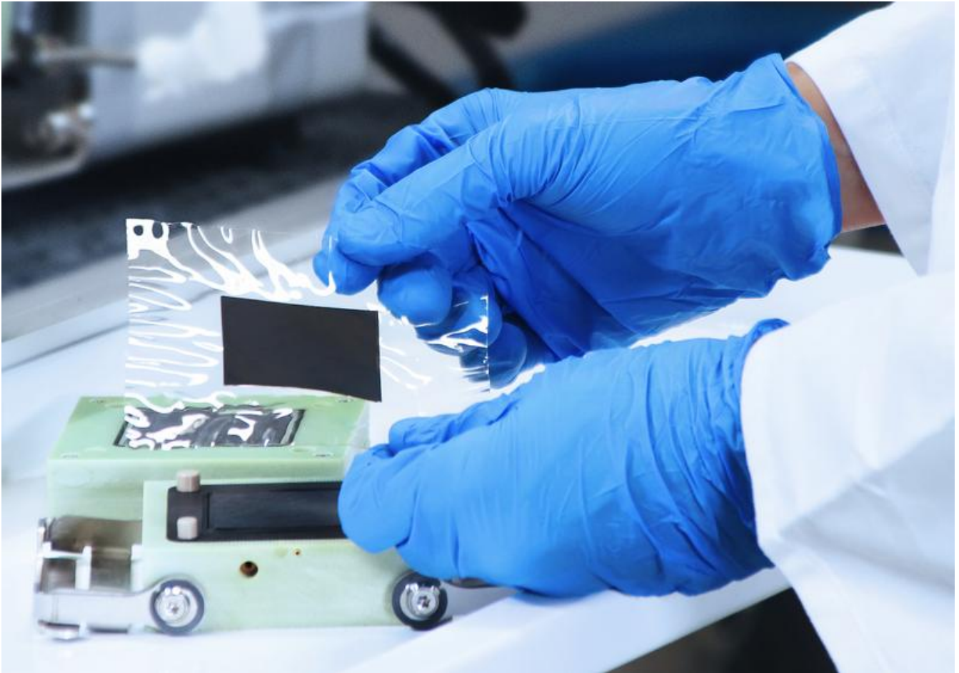
Charakterisierung von Brennstoffzellen: Ein neues Testsystem ermöglicht es, Brennstoffzellen mit den neu Katalysatoren zu testen und so die konstante Qualität der Katalysatorpartikel nachzuweisen.
